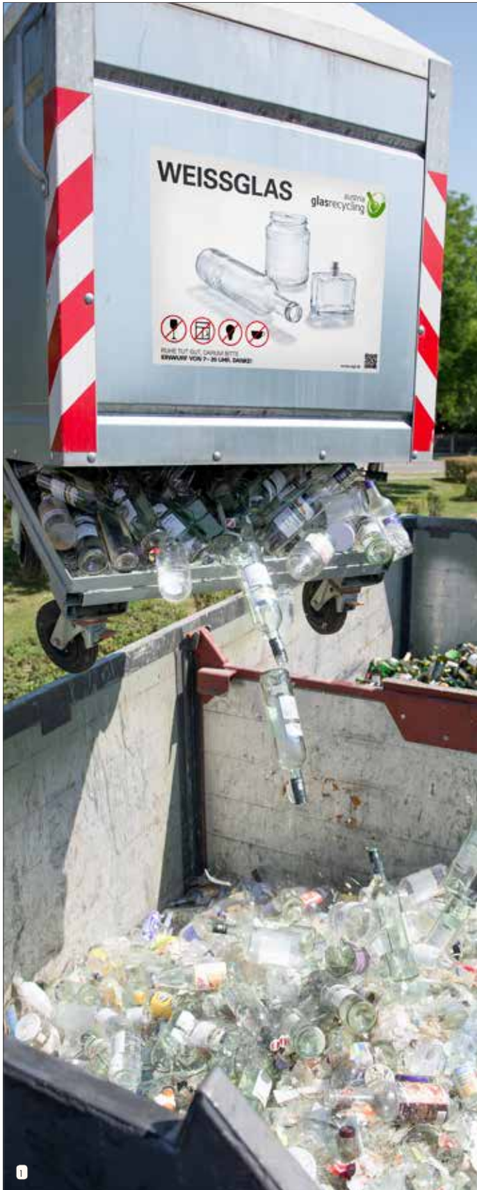
Getrenntes bleibt getrennt. Weißglas und Buntglas werden getrennt entsorgt, transportiert und verwertet. Die Trennwand im LKW-Anhänger gewährleistet, dass Weiß- und Buntglas getrennt bleiben.
