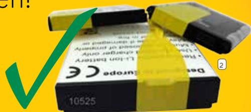
Lithium-Ionen-Akkus und -Batterien enthalten auch wenn sie „leer“ sind noch vergleichsweise viel Restenergie. Um bei der Lagerung bzw. später bei der Entsorgung einen möglichen Stromfluß und somit der Gefahr eines Brandes vorzubeugen, klebt man die Batteriepole bzw. -kontakte mit handelsüblichen Isolierband ab! Mehr Infos erhalten Sie in unserem Erklärvideo:
