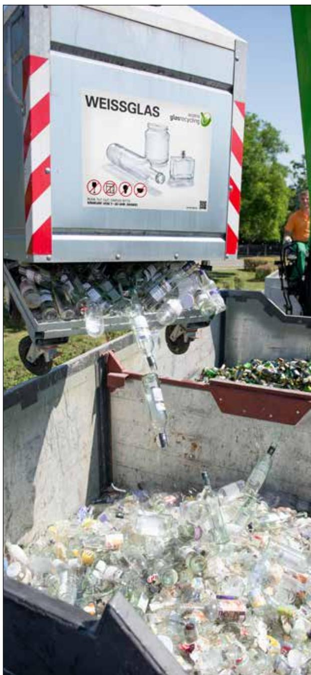
Getrenntes bleibt getrennt. Weißglas und Buntglas werden getrennt entsorgt, transportiert und verwertet. Die Trennwand im LKW-Anhänger gewährleistet, dass Weiß- und Buntglas getrennt bleiben. Foto: [www.agr.at](http://www.agr.at)
