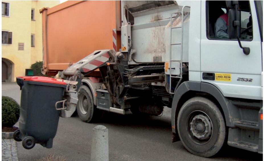
Die neuen Abfuhrfahrzeuge nehmen die Tonnen mittels eines ausfahrbaren Greiffarmes auf und entleeren sie seitlich in das Fahrzeug. Eine Presse verdichtet das Material. Durch „richtiges“ Aufstellen der Tonnen trägt man zu einer effizienteren Sammlung und dadurch zu einer geringeren Umweltbelastung bei.
