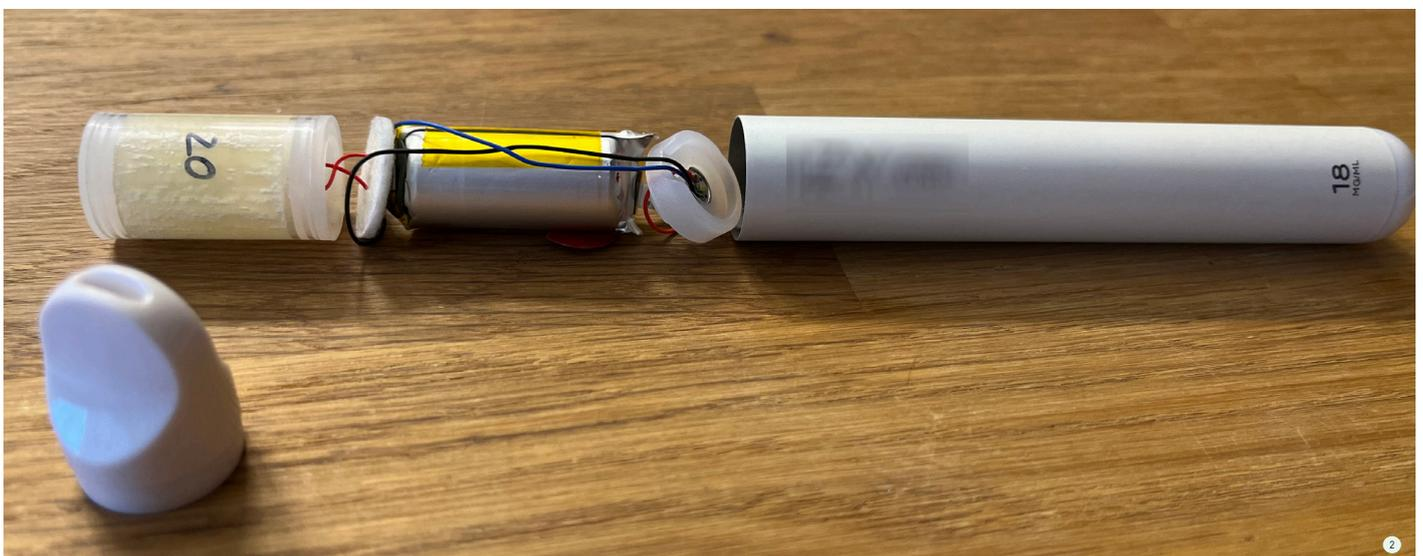
Aufbau einer Einweg-E-Zigarette mit Liquid-Tank und Batterie
